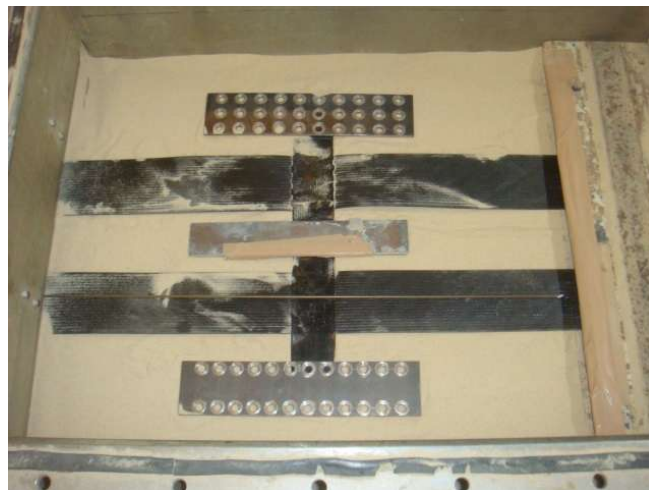
図 2-4 引抜き試験状況写真（敷設後）
