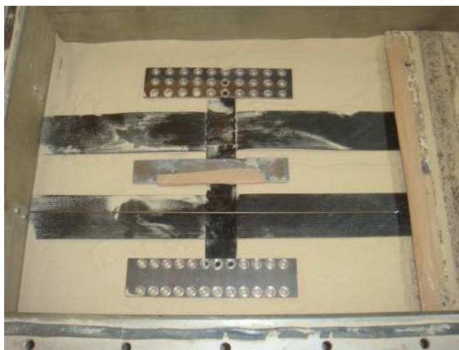
図 2-4 引抜き試験状況写真（敷設後）
