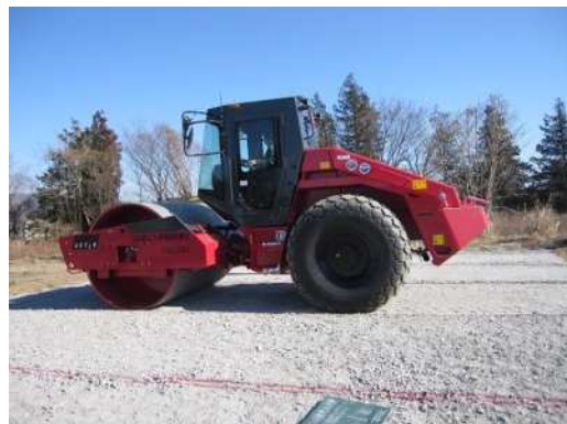
転圧力 324kN (大土工対応：今回損傷試験)
