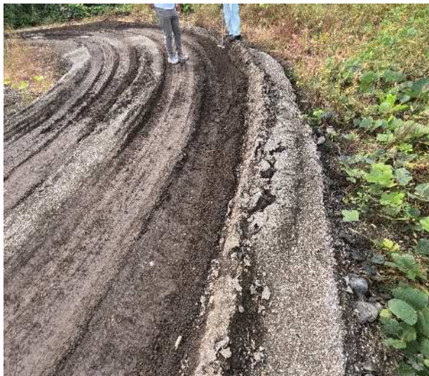
Case4 ジオセル+RC40 ジオセル破損
